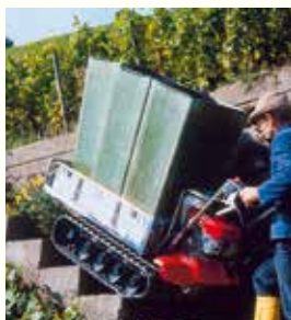
HP 500 transportmaskin på vei opp trapper
