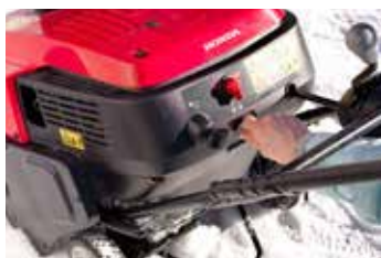
Praktisk hendel for manuell justering av utkast
