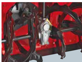
Bryteboltvakt/sensor (innmaterskrue med autostopp)
